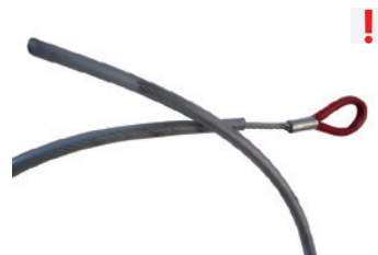
narušená krytka – servis
