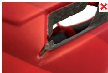
poškození části seřizovacího systému
