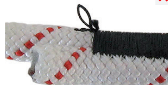
poškození pevnostního šití
