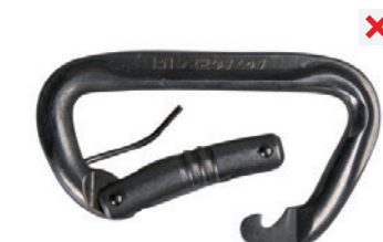
nefunkčnost zámku, vytržená část karabiny
