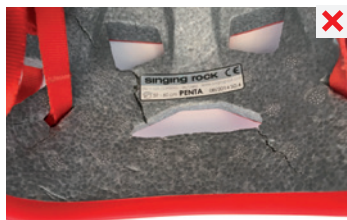
narušená konstrukce absorbční vložky přilby
