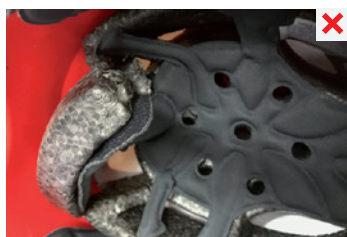
poškození skořepiny zahřátím
