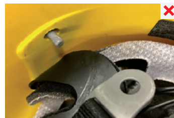
poškození uchycení hlavového kříže
