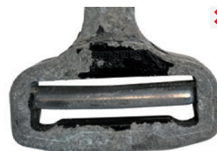
koroze spony po potřísnění maltou
