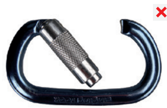
chybějící část karabiny
