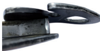
úbytek materiálu na kyvné straně zachycovače pádu
