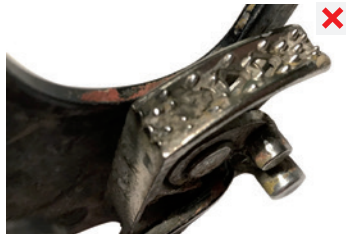
úbytek materiálu - omezuje funkčnost
