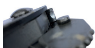
úbytek materiálu na pevné straně zachycovače pádu
