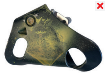
znečištění - nečitelné výrobní číslo
