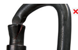
chybějící část karabiny
