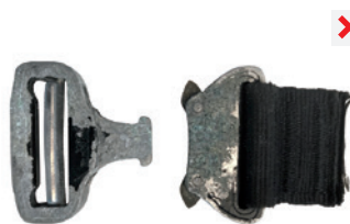
koroze spony při znečištění maltou
