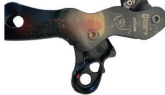
znečištění - nečitelné výrobní číslo
