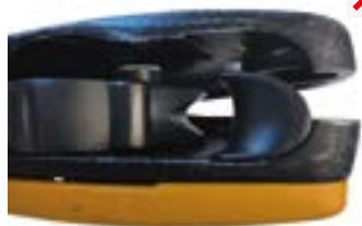
znečištění - nečitelné výrobní číslo
